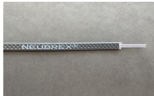
FN-EBSM-01は、光ファイバ分布計測用に設計されたひずみ・温度計測センシングケーブルです。機械・熱負荷に対する直線性に優れており、精度の高いひずみ・温度分布計測を可能にします。ケーブル中心部にシングルモード・マルチモード光ファイバ各1本を内蔵し、マルチモード光ファイバをDTS(Distributed Temperature Sensor)機器に接続することでケーブル1本でひずみ計測と温度補償の両方を実現することができます。
